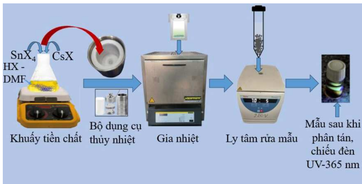
Hình 2.1. Sơ đồ minh họa quy trình tổng hợp \text{Cs}_2\text{SnX}_6 ( \text{X} = \text{Cl}, \text{Br} ) bằng phương pháp thủy nhiệt.
