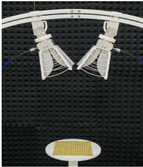
Hình 2.8. Thiết lập đo MA và MMA trên hệ thiết bị VNA
