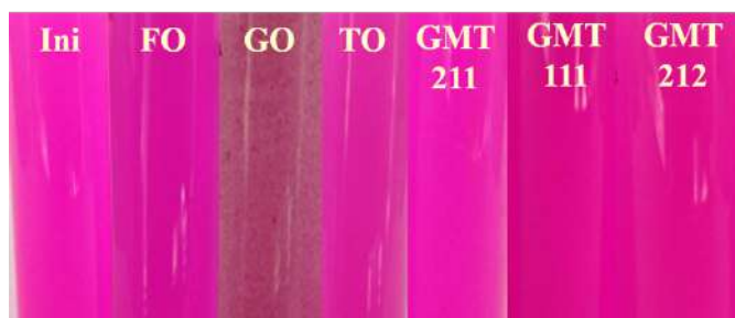
Hình 3.62. Trạng thái dung dịch RhB sau khi thực hiện thí nghiệm quang hóa trên các vật liệu và nguyên liệu (Ini: dung dịch RhB 10 ppm ban đầu).
