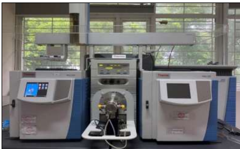
Hình 2.4. Thiết bị sắc ký khí khối phổ phân giải cao
