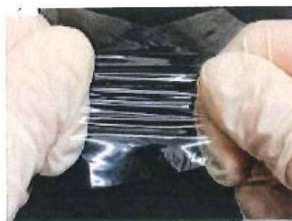
Hình 1. 2. Màng mỏng được tạo thành từ các tinh thể nano chitosan, glycerol và chitin [11].
