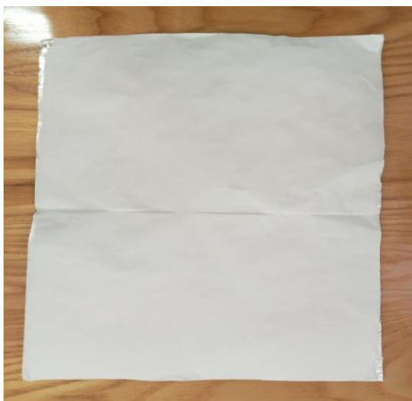
Hình 15. Ảnh sợi nano CS/PLA/PEG/CAP12 sau khi thực hiện quá trình kéo lực điện trường ở các điều kiện tối ưu
