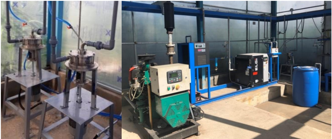
Hình 1.24. Thiết bị HGRPB trong mô hình xử lý bùn thải nhà máy bai Sài Gòn tại Đắc Lắc [151]
