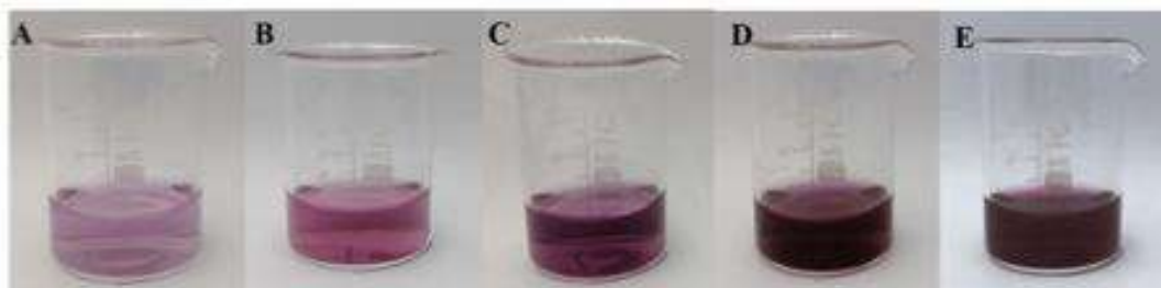
Hình 3.8. Các mẫu AuNps được tổng hợp bằng Plasma jet với thời gian khác nhau: (A) 2 phút; (B) 5 phút; (C) 7 phút; (D) 10 phút và (E) 15 phút.
