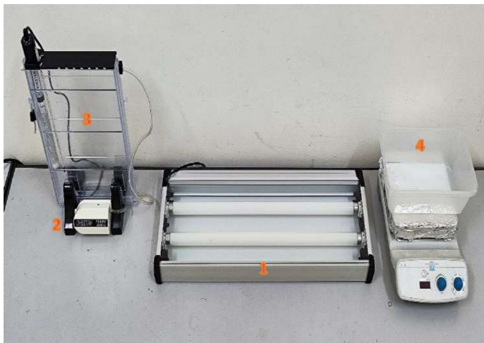
Hình 2.5. Hệ thiết bị quang khắc gồm 4 phần chính: 1) Thiết bị chiếu sáng, 2) hệ thống bơm hút, 3) bể ngâm chứa dung dịch ăn mòn và 4) bể ngâm chứa dung dịch hiện hình.
