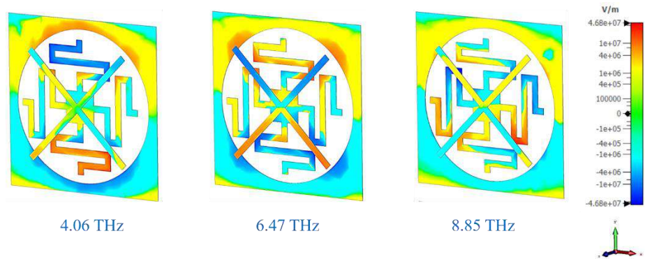
Hình 5.23. Phân bố điện trường của cấu trúc MMA với d_1 = d_2 = 0,5 tại tần số 4,06, 6,47 và 8,85 THz ở chế độ EIT
