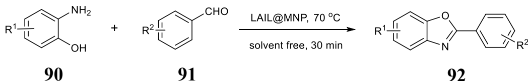
Hình 1.37. Tổng hợp các dẫn xuất benzoxazole từ o -aminophenol và aldehyde bằng chất lỏng ion acid Lewis
