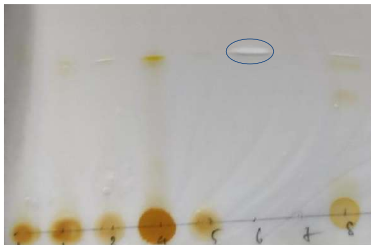
Hình 3.22. Sắc ký lớp mỏng (TLC) của chiết xuất nấm trên các môi trường có nguồn đường khác nhau (Đường số 1: Inositol, đường số 2: Mannitol, đường số 3: Tinh bột tan, đường số 4: Sucrose, đường số 5: D-maltose, đường số 6: Chất chuẩn-PTOX, đường số 7: ĐC (-), đường số 8: Dextrose)
