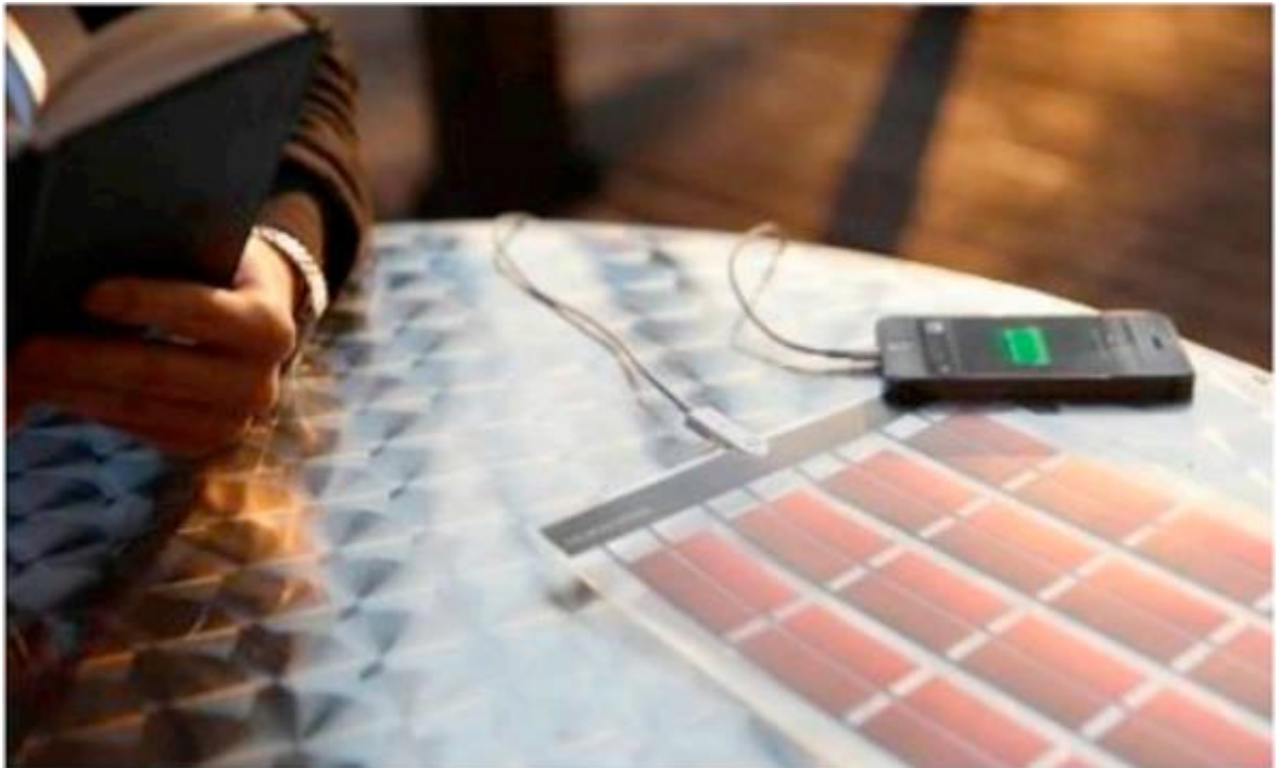
c. Tấm hấp thụ năng lượng mặt trời sử dụng để sạc pin cho thiết bị điện tử Hình 1.4. Một số ứng dụng của tấm biến đổi năng lượng mặt trời thành điện năng [68]- [70].
