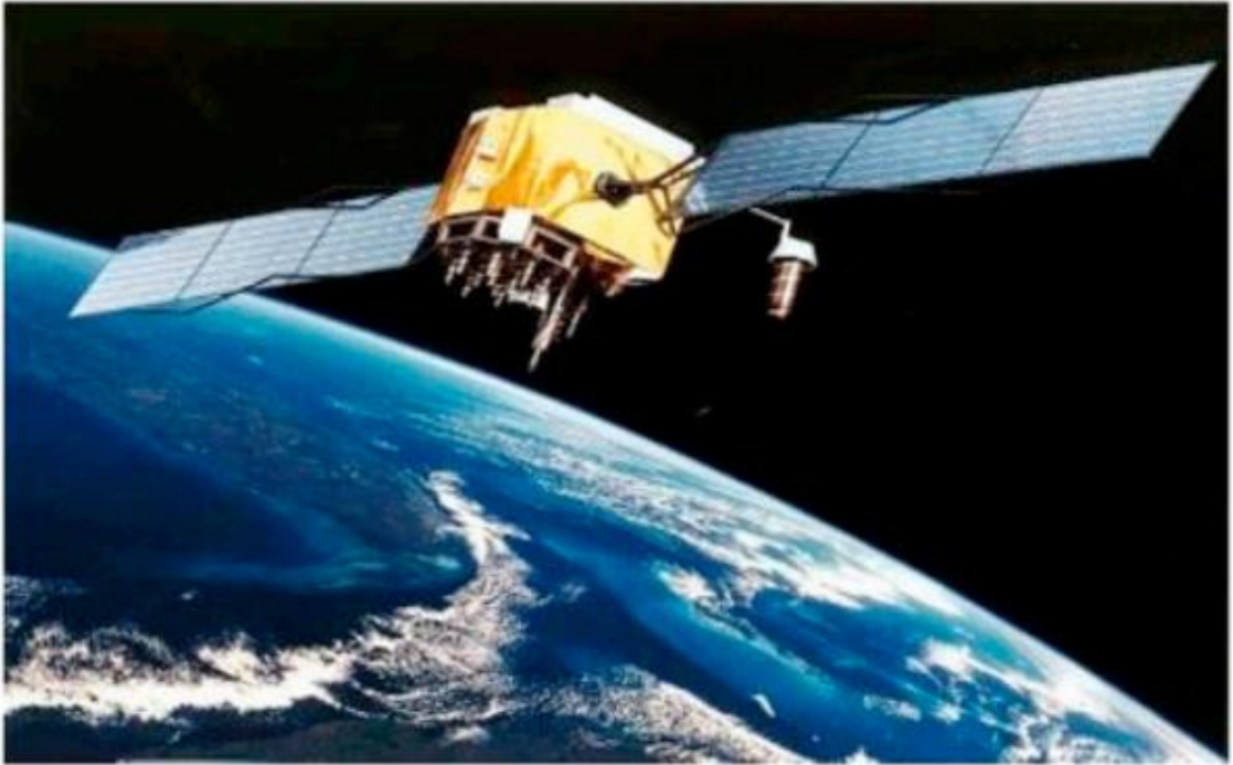
b. Tấm hấp thụ năng lượng mặt trời sử dụng trong các vệ tinh không gian
