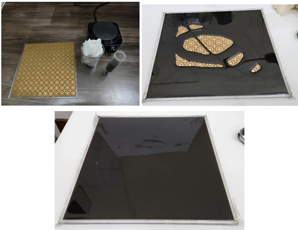
Hình 2.15. (a) Chuẩn bị vật liệu từ và vật liệu kết dính; (b) Phối trộn nguyên liệu, tạo lớp phủ lên cấu trúc MA; (c) Đóng rắn và tạo hình mẫu
