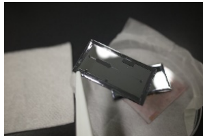
Hình 2.10. Một trong các mask chứa chi tiết kênh dương (nổi) được chế tạo bằng phương pháp quang khắc.
