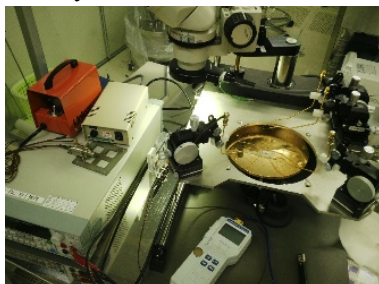
Hình 2.18. Kiểm tra khả năng hoạt động của đế nhiệt với hệ 4 đầu dò.
