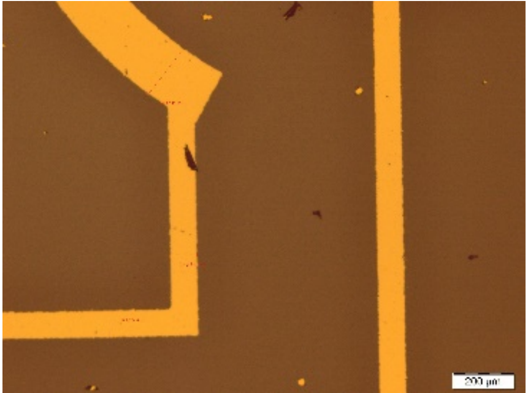
Hình 2.15. Ảnh chụp điện cực vàng từ kính hiển vi điện tử
