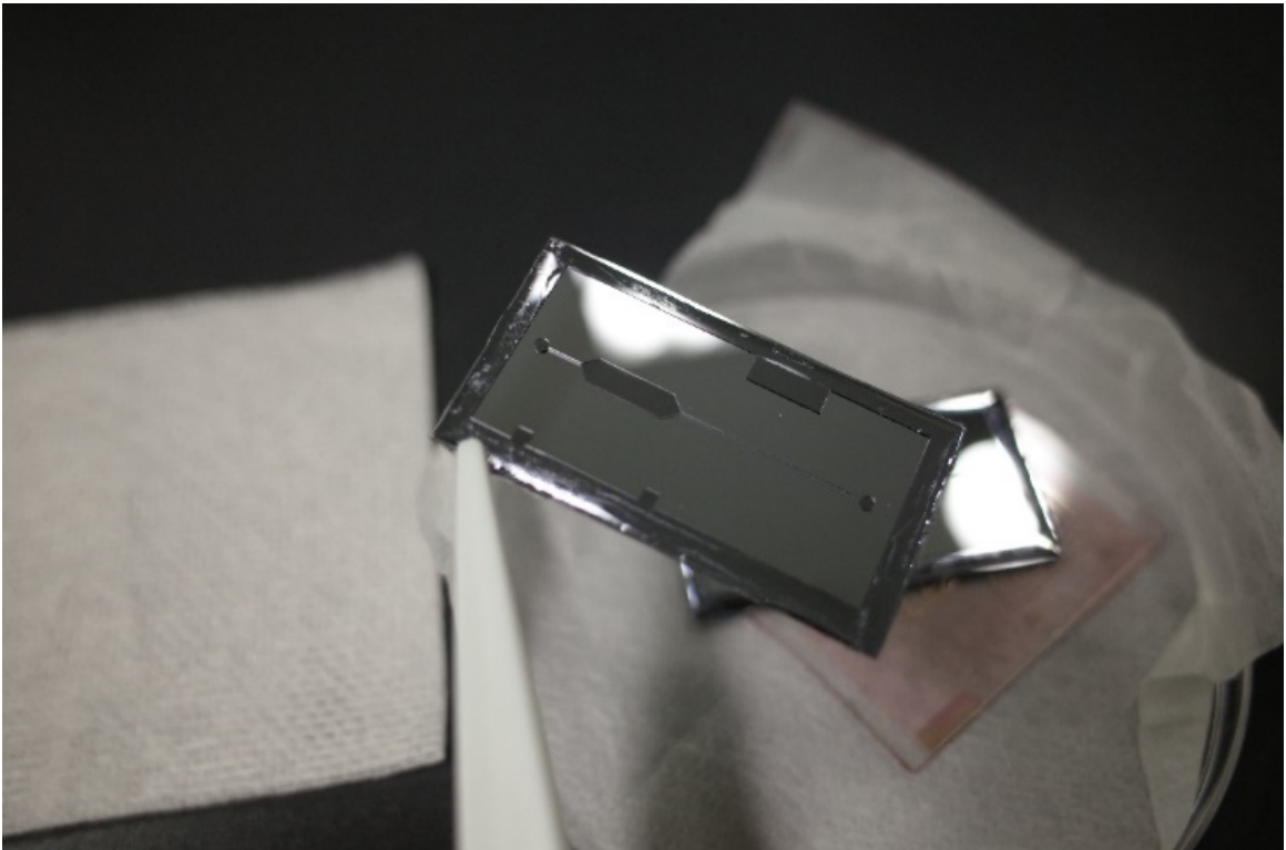
Hình 2.10. Một trong các mặt nạ chứa chi tiết kênh dương (nổi) được chế tạo bằng phương pháp quang khắc.
