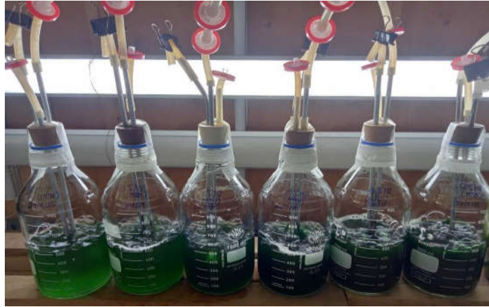
Hình 1.9. Khảo sát S. salina M8 trong nước thải sinh hoạt với tỷ lệ tảo giống khác nhau
