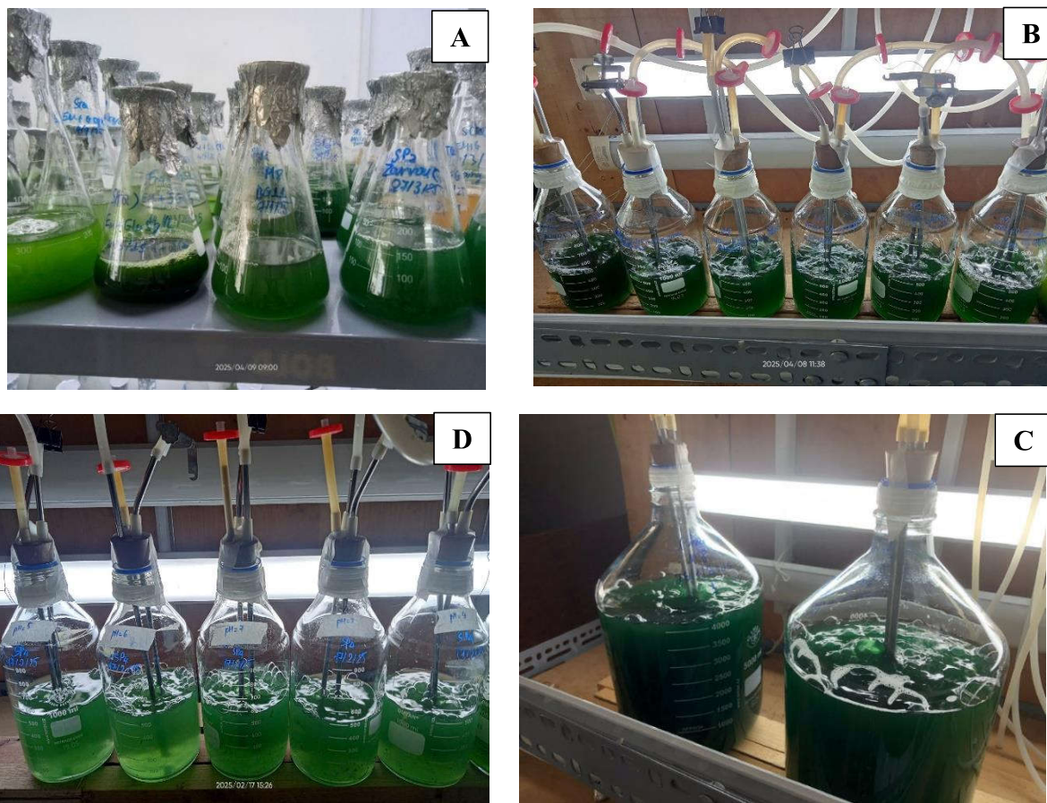
Hình 1.3. Quy trình nhân giống và khảo sát sinh trưởng và sản xuất PHB bởi vi khuẩn lam S. salina M8, Spirulina SP2, và Spirulina SP4 trong môi trường BG-11 và Zarrouk tương ứng. Nhân giống trong bình 250 mL (A), nhân giống trong bình 1000 mL (B), nuôi khảo sát trong bình thủy tinh 5000 mL (C), khảo sát tăng trưởng và PHB của S. salina M8, Spirulina SP2, và Spirulina SP4 trong bình 1000 mL (D).
