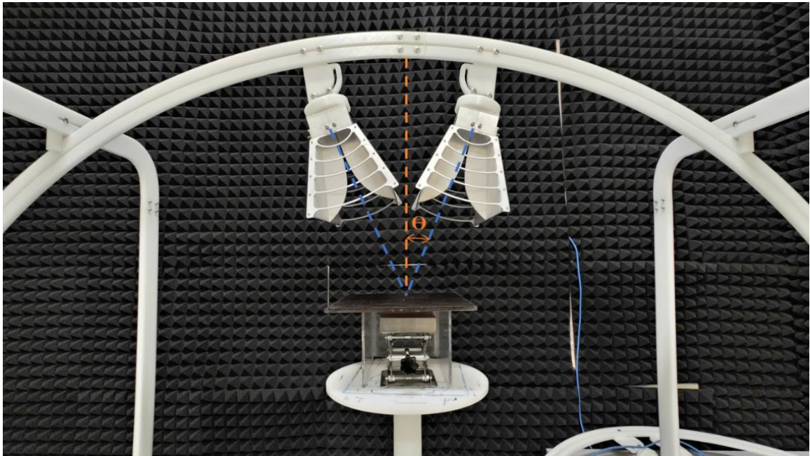
Hình 2.17. Sơ đồ bố trí thí nghiệm sử dụng hệ thiết bị VNA đo đặc trưng phản xạ của vật liệu biến hóa
