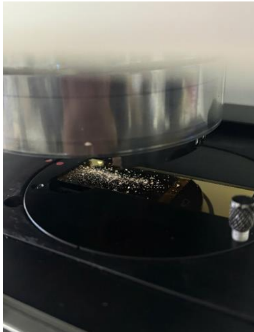
Hình 2.4. Phân tích nhận diện diện polymer bằng máy \mu\text{-FTIR}
