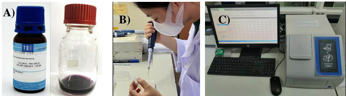
Hình 4.5. Hình ảnh minh họa thử nghiệm xác định hoạt tính chống ô xy hóa bằng trung hòa gốc tự do DPPH. (A) Chuẩn bị DPPH nồng độ 0,2 \mu\text{M} ; (B) Hút lần lượt hỗn hợp phản ứng vào đĩa 96 giếng; (C) Đo \text{OD}_{517\text{nm}}
