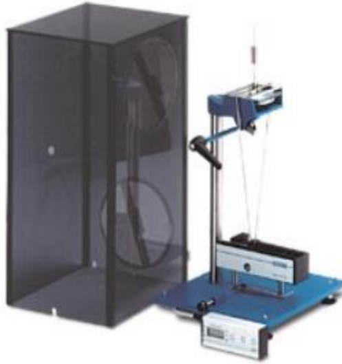
Hình 2.4 Thiết bị đo độ cứng tương đối Erichsen, model 299/300
