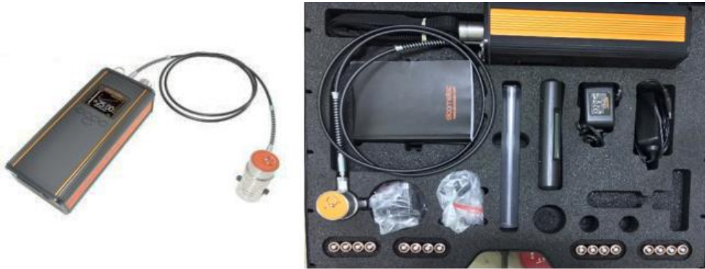
Hình 2.6 Thiết bị Elcometer F510 – model T xác định độ bám dính của màng sơn.
