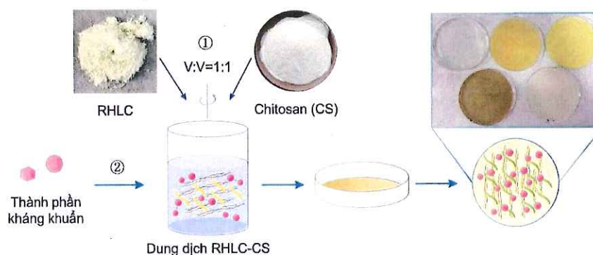
Sơ đồ 1.3 Quy trình chế tạo màng chitosan chứa hoạt chất và sự hình thành cấu trúc mạng polymer thông qua tương tác liên phân tử
