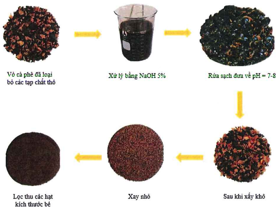
Hình 2.1. Sơ đồ quy trình thu bột lignocellulose từ vỏ quả cà phê
