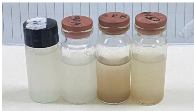
Hình 3.2. Hình ảnh các mẫu CZ tổng hợp bằng phương pháp hóa học với các chất hoạt động bề mặt khác nhau khi phân tán trong nước, từ trái sang phải: CZ-0, CZ-PVA, CZ-SDS, CZ-CTAB
