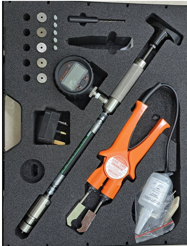
Hình 2.4. Hình ảnh thiết bị kiểm tra độ bám dính phủ tự động
