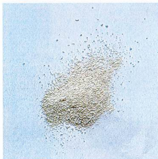
Phụ lục 6: Ảnh g-C 3 N 4 biến tính plasma DBD trong 90 phút, lưu lượng dòng khí 2 lít/phút
