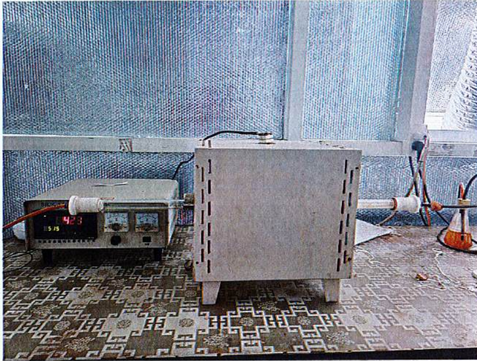
Phụ lục 11: Hệ thống lò nung ống dùng biến tính bề mặt g-C_3N_4 nung 500^\circ C trong dòng khí Nitơ
