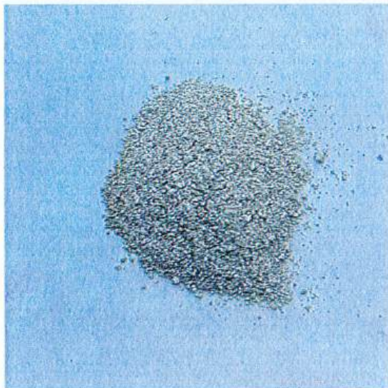
Phụ lục 8: Ảnh g-C 3 N 4 biến tính plasma DBD trong 90 phút, lưu lượng dòng khí 3 lít/phút
