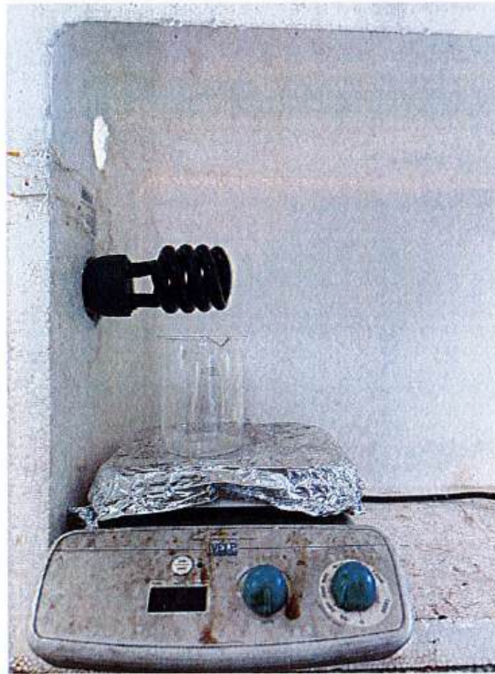
Phụ lục 10: Hệ thống Quang hóa đèn UV xử lý màu Reactive black 5
