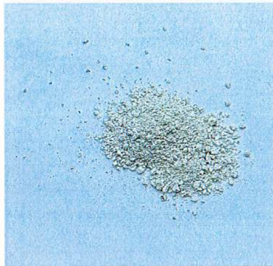
Phụ lục 2: Ảnh g-C 3 N 4 biến tính bằng nung 550°C trong khí N 2
