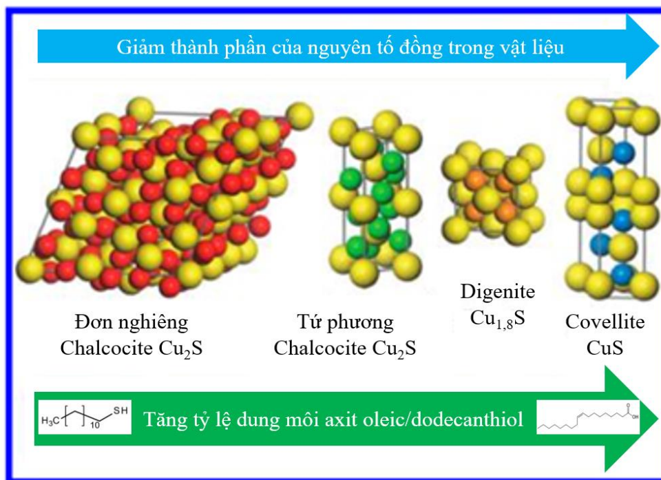
Hình 1.16. Các sản phẩm \text{Cu}_{2-x}\text{S} được hình thành bằng phương pháp CVD [104].
