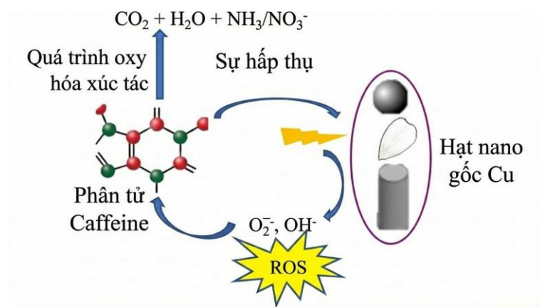
Hình 1.6. Cơ chế phân hủy chất ô nhiễm caffein của hạt nano
