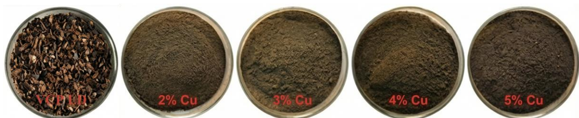
Hình 3.2. Ảnh chụp vỏ cà phê Lâm Đồng và vật liệu nano gốc Cu/vỏ cà phê ở các hàm lượng Cu khác nhau
