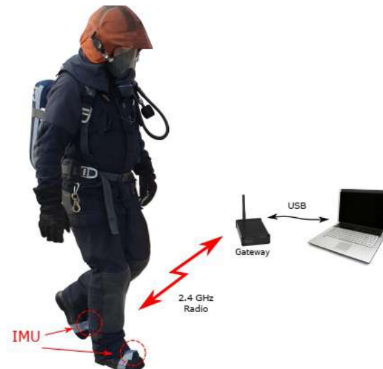
Hình 1.3: Cấu hình hệ thống cảm biến IMU 1 gắn trên ủng của lính cứu hoả và sơ đồ truyền dữ liệu qua liên kết vô tuyến 2.4 GHz
