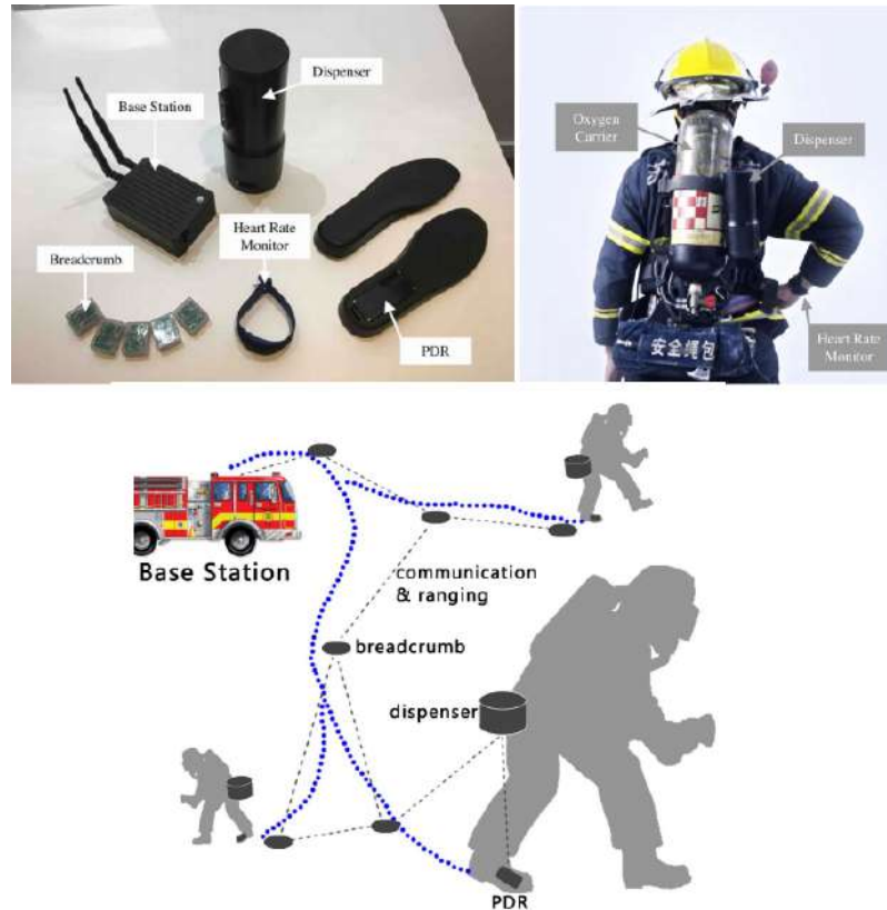
Hình 1.4: Kiến trúc hệ thống định vị lai kết hợp Breadcrumb, PDR cho lính cứu hoả 1 .
