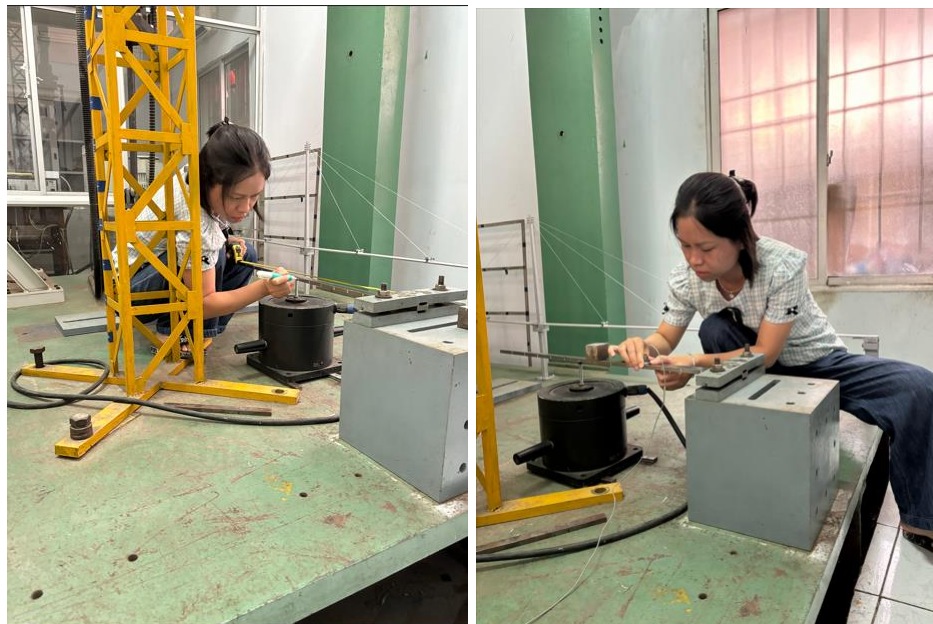
Hình 4. 5. Đo đặc hàm receptance của dầm
