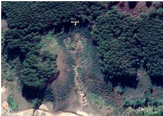
Hình 2.6. Kiểu trượt dòng (EFl), trên sườn dốc tại xã Tà Nung, Tp. Đà Lạt: a) Mặt cắt mô tả và b) Ảnh chụp Google Earth (2018)
