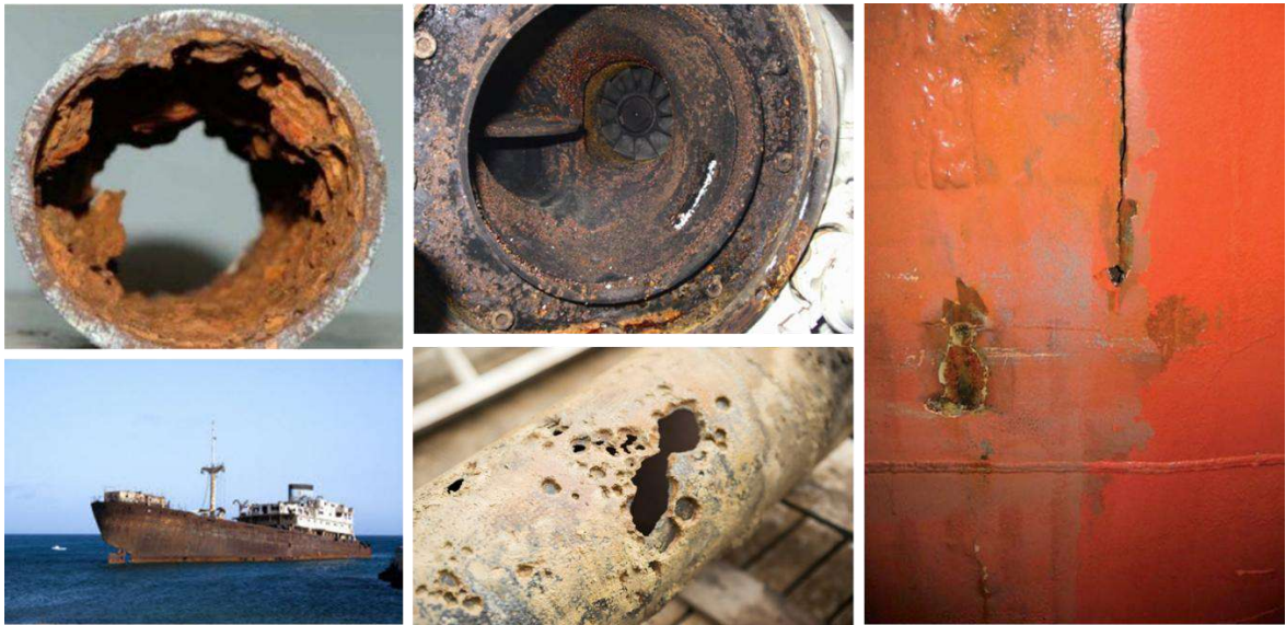
Hình 1.4. Hình ảnh mô tả hậu quả do ăn mòn \text{CO}_2 trong tự nhiên.
