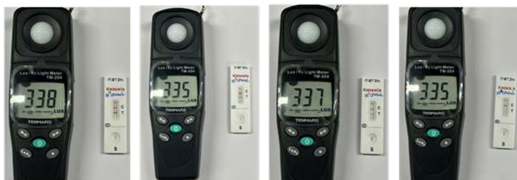
Hình 3.32. (A) Que thử LFIA được đánh giá khả năng phát hiện K.pneumoniae trong dải nồng độ từ 10^1 đến 10^8 CFU/mL (B) Các hình ảnh của que thử LFIA được chụp dưới điều kiện chiếu sáng với độ rọi 335 lux. Sau đó, các hình ảnh này được phân tích cường độ màu tại vạch thử (T-line) bằng phần mềm Color Grab.
